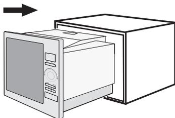
4. 將產品放入廚具中後，固定器會卡入產品的固定槽，將產品固定在廚具中。
