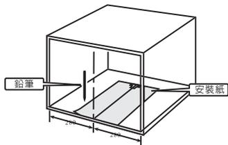
2. 取出安裝紙，在標記好的孔位上沾孔。然後將固定器放置在標記位置上，用螺釘B固定。（打孔直徑： $\varnothing 3\text{mm}$ ）
