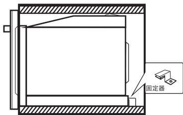
5. 打開爐門，用螺釘A將產品固定在廚具上。然後將塑料蓋固定在安裝孔上。
